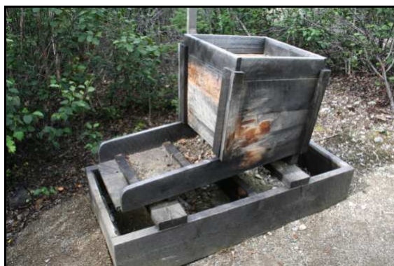
Abb. 54: Das Tal des Bonanza Creek ist wie ein großes Freiluftmuseum für die Goldgewinnung. Hier eine einfache Goldwaschanlage aus Holz.
